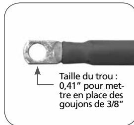
Fig. 3,13. Terminaison câble positif
